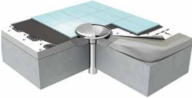
Su gideri uygulama kesiti 2
