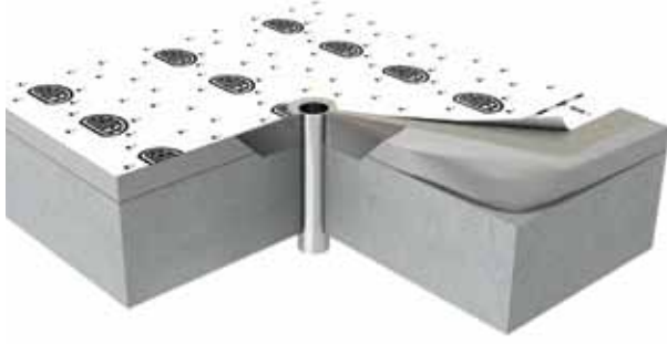
Su gideri uygulama kesiti 1
